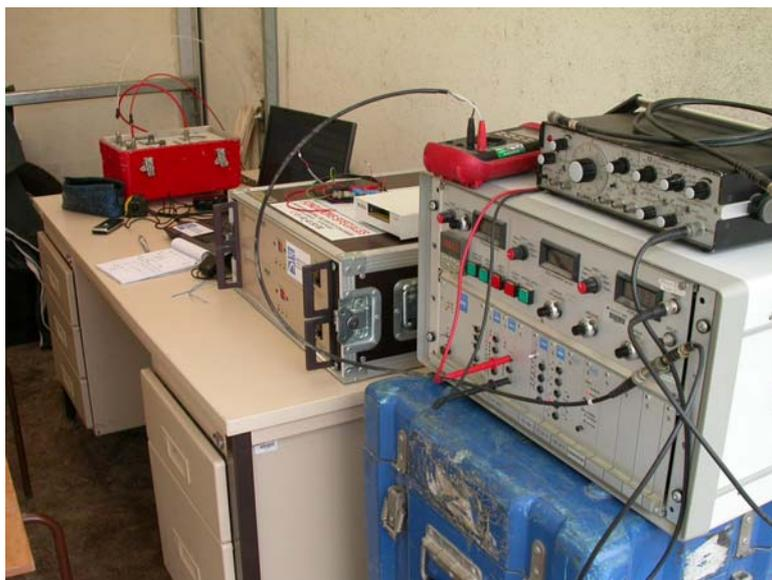
Figure 28 Système d'acquisition (vérin, capteurs de déplacement et jauges extensométriques) et système de pilotage du vérin hydraulique
