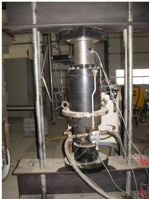
Figure 9 Photo – Vérin de chargement, essai de vérification
