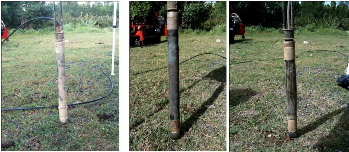
Figure 25 type de gaine carat, souple toilée, lamelles métalliques
