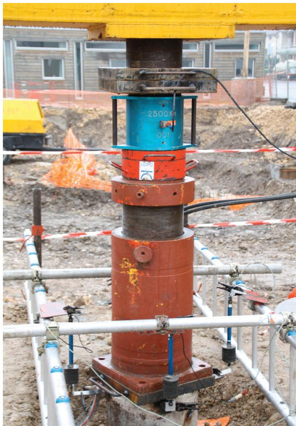
Figure 3 : photo du vérin hydraulique de 300T
