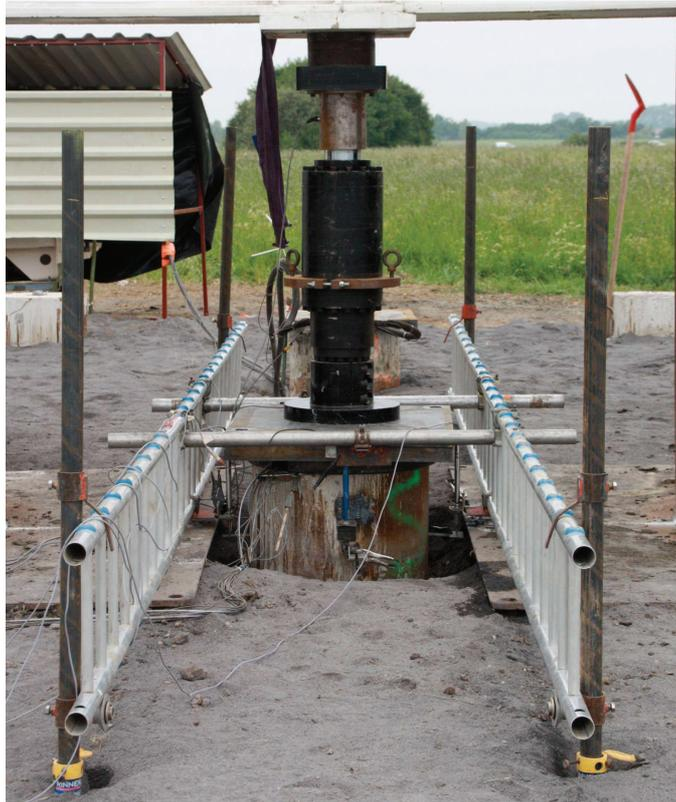
**Figure 5 : Vérin hydraulique cyclique en opération**
