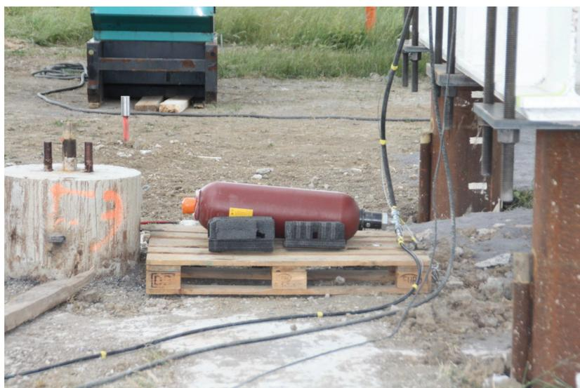
Figure 14 : photo de l'accumulateur
