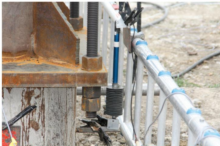
**Figure 7 : capteur LVDT de 125 mm de course**
