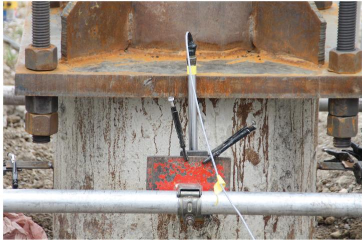
**Figure 6 : capteur LVDT de 50 mm de course**
