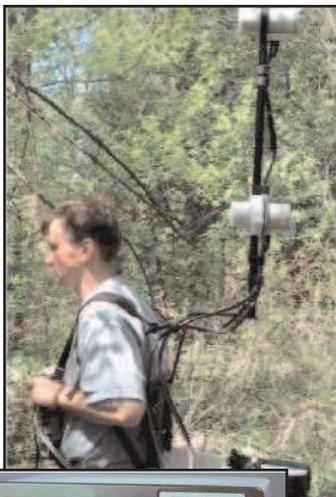
Ce type d'appareil permet de mesurer le gradient vertical du Champ magnétique terrestre. Il se compose de deux magnétomètres situés à deux altitudes différentes (sur la photo à 58 cm l'un de l'autre).
