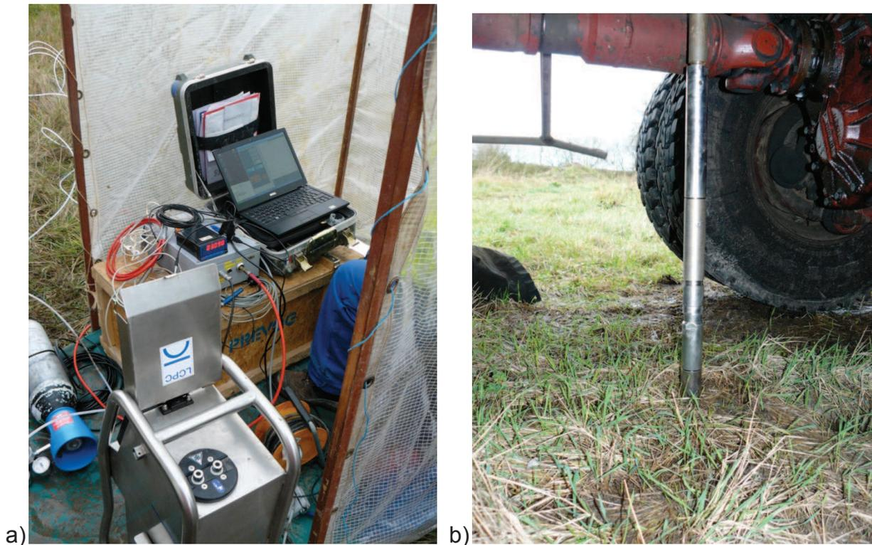
Figure 9. Poste de pilotage et enfoncement de l'appareil dans le sol
