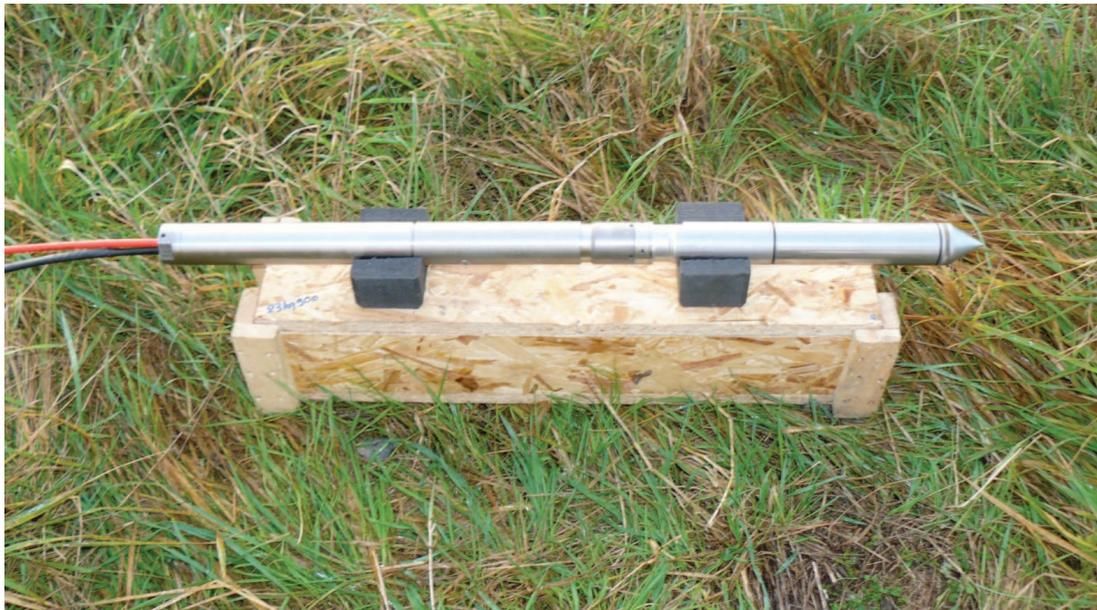
Figure 7. Le manchon de frottement fixé au dessus de la pointe (S15-CFIP.484)
