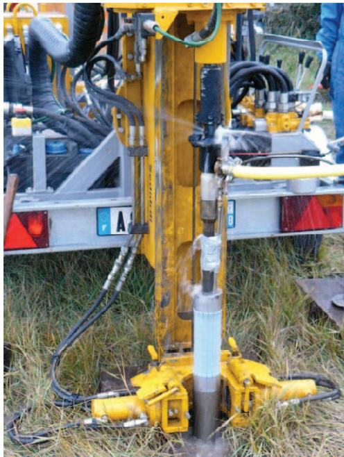
Figure 29. Vue de la pénétration du PAF dans le sol
