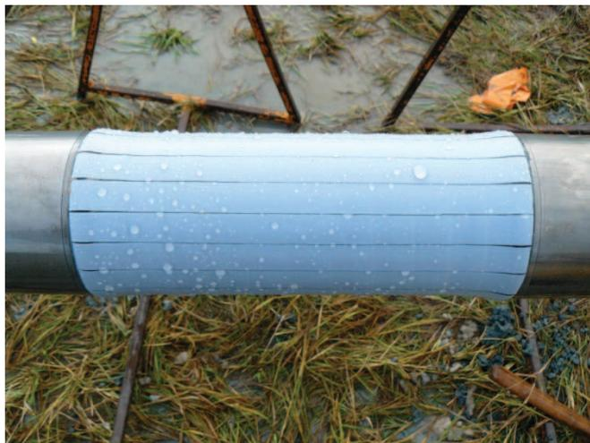
Figure 32. Membrane après extraction de la sonde et lavage
