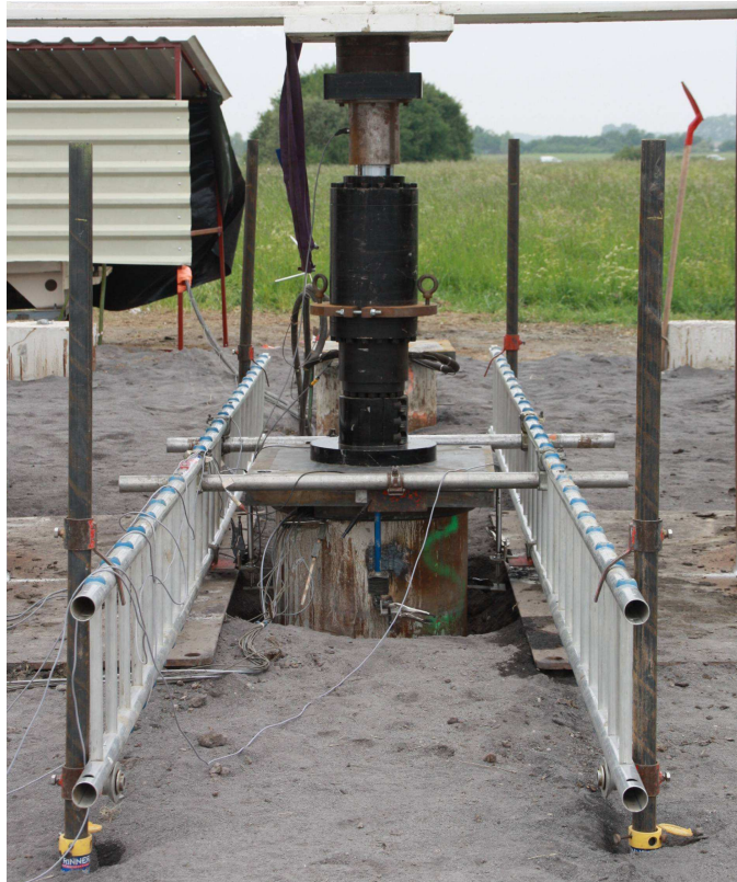
Figure 5 : Vérin hydraulique cyclique en opération
