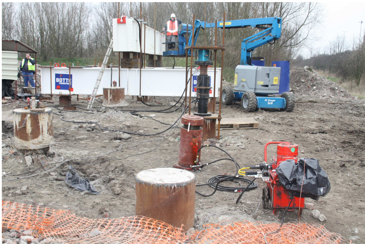
Figure 3 : photo du vérin hydraulique de 300T
