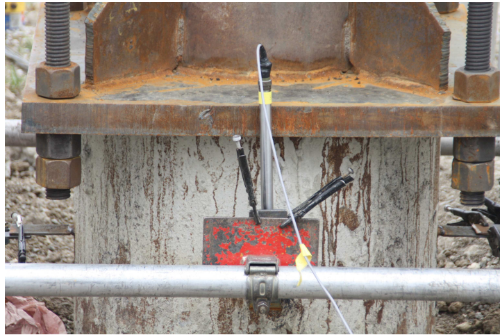
Figure 6 : capteur LVDT de 50 mm de course
