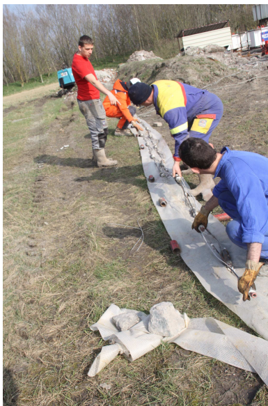
Figure 9 : photos de l'extensomètre amovible
