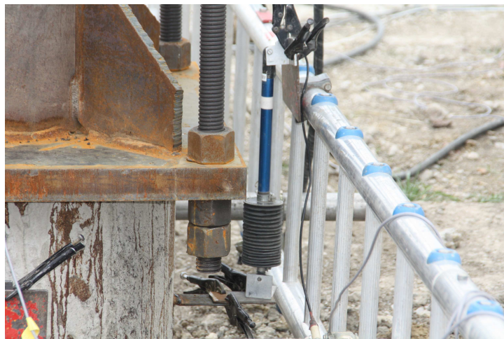
Figure 7 : capteur LVDT de 125 mm de course
