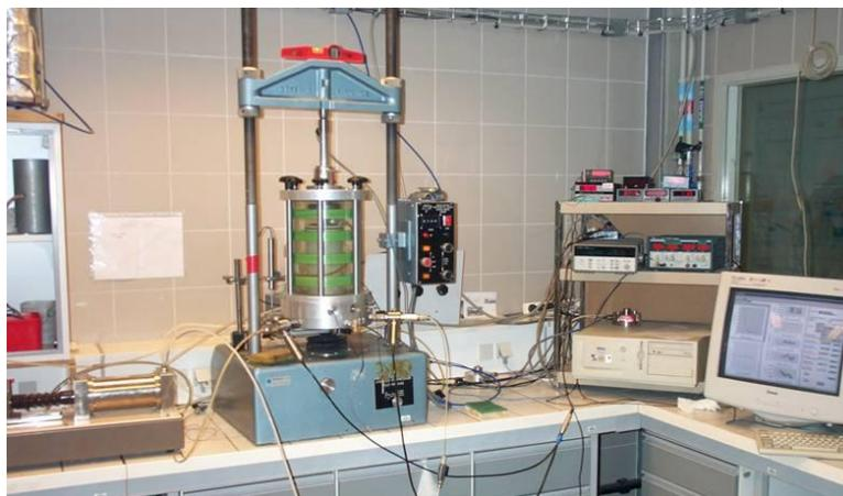
*Figure 5 – Dispositif triaxial utilisé pour les essais de cisaillement monotone*
