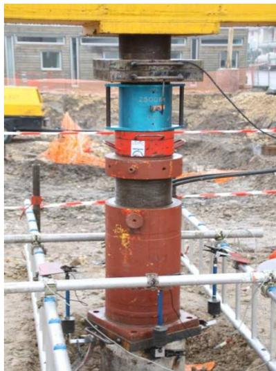
*Figure II-17 : Photo du vérin hydraulique de 300T*
