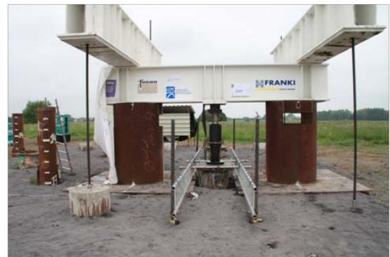
Figure 4 : Dispositif de chargement des pieux en compression.
