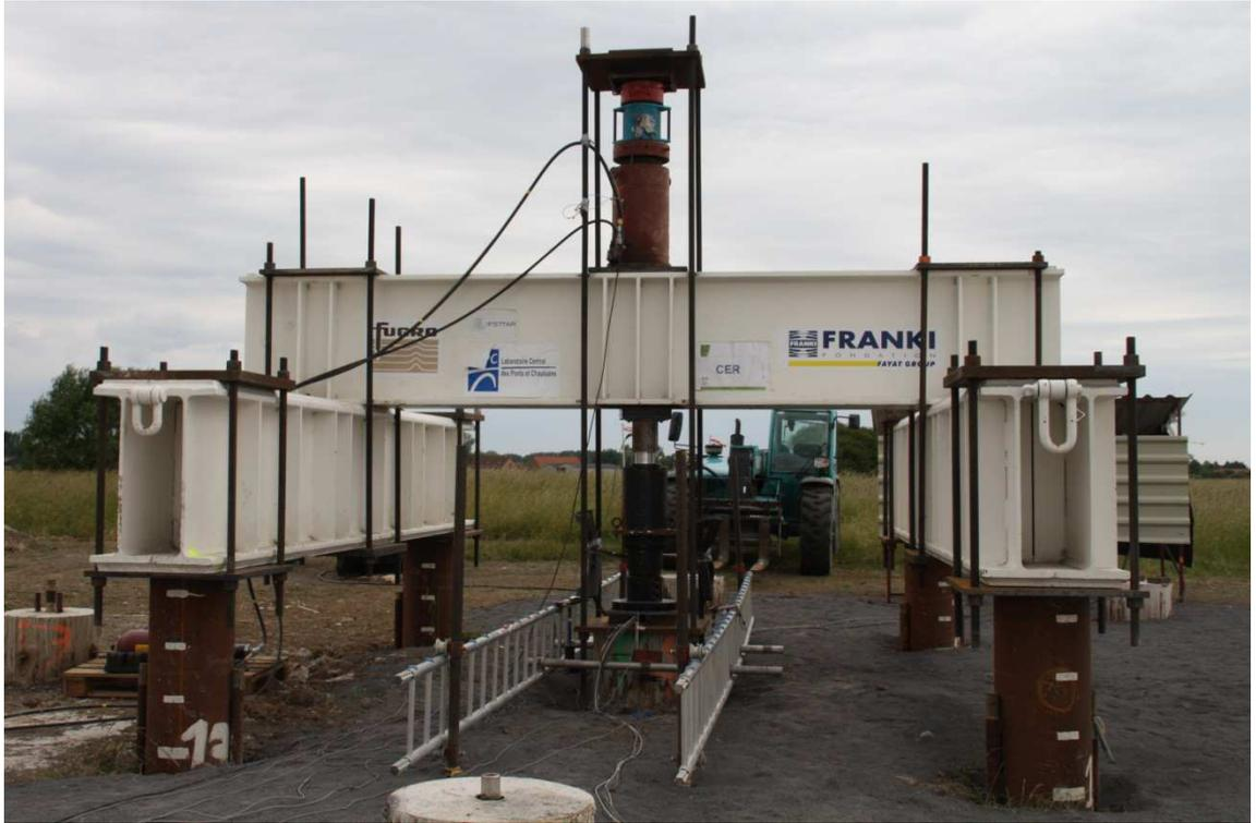
*Figure II-28 : Photo du montage d'un essai de chargement cyclique alterné*
