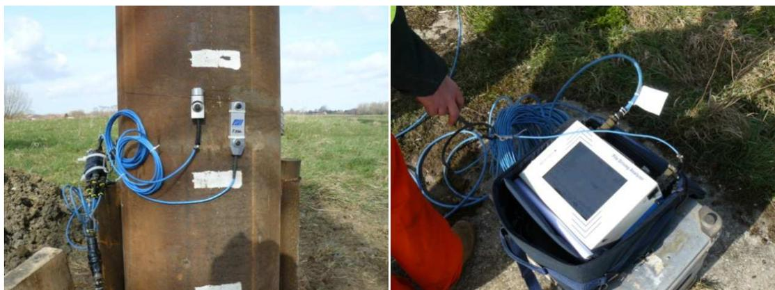
*Figure II-19 : Le système d'instrumentation de battage.*
