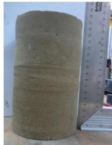
**Figure 2.1 : Tronçons de carotte de calcarénite.**
