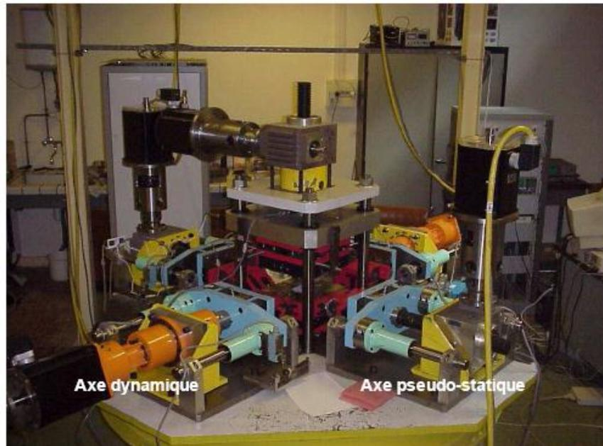
**Figure 4.1 : La machine de cisaillement direct BCR3D**
