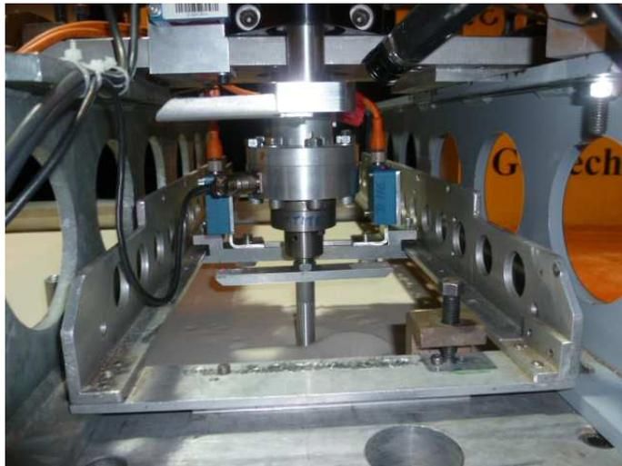
**Figure 1.4.** Essai de pieu sous charge axiale dans la centrifugeuse IFSTTAR
