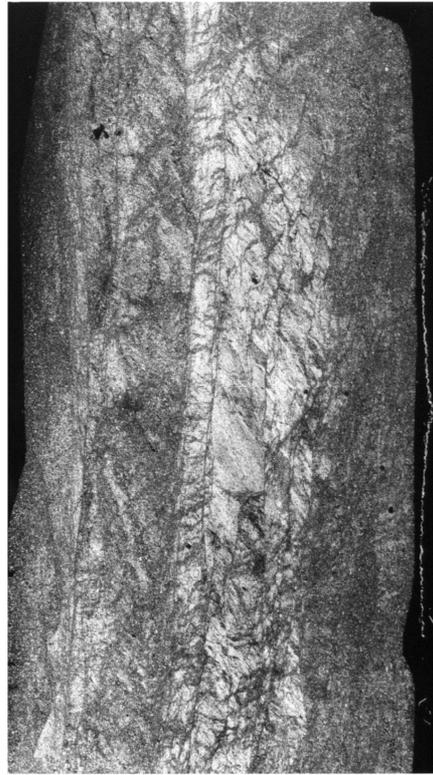
**Figure 7.2.** Coupe d'une couche fine d'argile (15x 40mm) adhérent à la paroi du pieu ICP à Pentre (d'après Chow, 1997). On distingue plusieurs surfaces verticales de cisaillement résiduelles.
