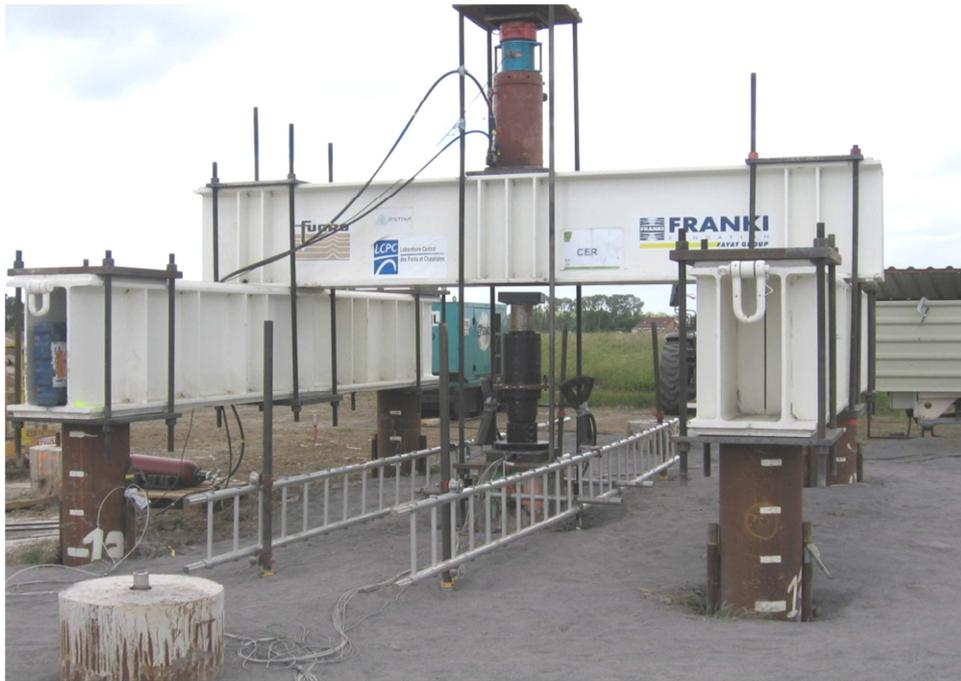
**Figure 1.2.** Dispositif de chargement des pieux pour essais cycliques alternés
